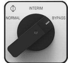
**Warnung:** Wenn der Bypass aktiv ist, ist das System anfällig für AC-Netzstörungen. Bevor Sie die Handumgehung aktivieren, stellen Sie sicher, dass die Spannungsdifferenz zwischen AC-Eingang und AC-Ausgang weniger als 5 VAC beträgt, um den Einschaltstrom zu begrenzen.
