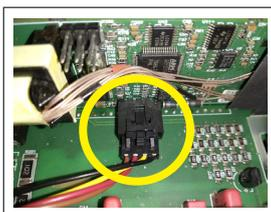
Neuen Ventilator einsetzen und Anschluss befestigen
