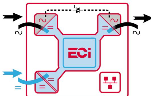
La technologie ECI **élimine tous les points de défaillance** avec une modularité complète ; jusqu'à 32 modules en parallèle et un rendement élevé pouvant atteindre jusqu'à **96 % pour la conversion CA/CA**, et dépassant **93,5 % pour la conversion CC/CA**, d'où une diminution des coûts d'exploitation. Nos systèmes peuvent être configurés jusqu'à **2,7 MVA**.
